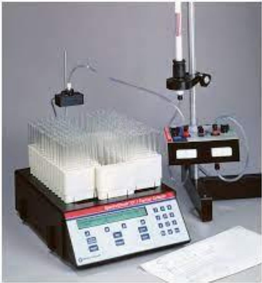
Cromatografía en columna: sílica gel, tamaño de partícula de 40–75 \mu\text{m} . Disolvente: etanol en diferentes concentraciones: 5 %, 10 %, 20 %, 40 %, 60 %, 75 %
